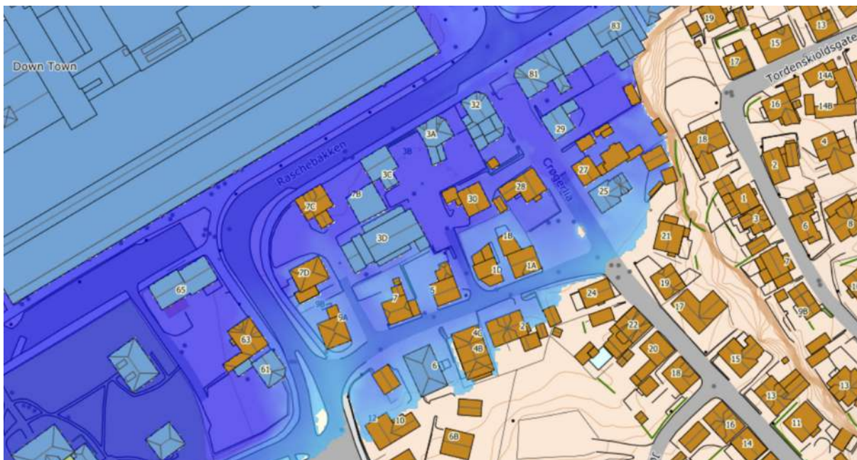
Figur 13 Beregnet flomnivå på kote 3,1 (VA-rammeplan, Prosjektil).
