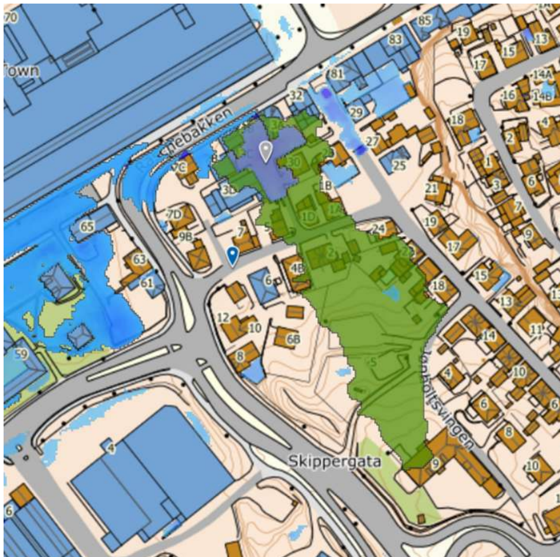
Figur 12 Det blå området er utsatt for oversvømmelse ved et skybrudd, det grønne området er nedslagsfeltet (VA-rammeplan, Prosjekttil).
