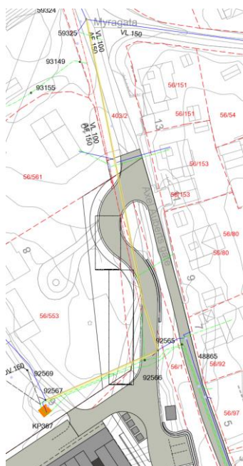
Figur 2-2 Vannledning som er aktuell å oppgradere til en 150 mm-ledning.
