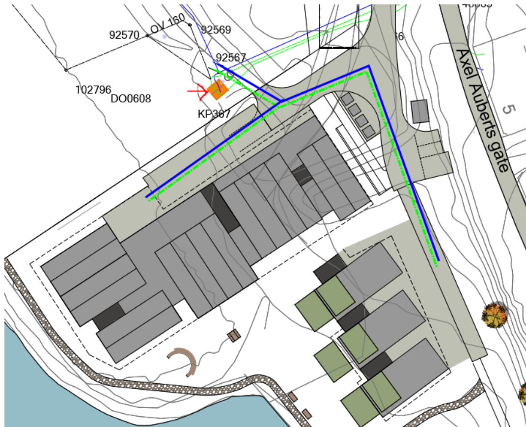
Figur 3-1 Lokasjon for spillvannspumpestasjon markert med rød pil
