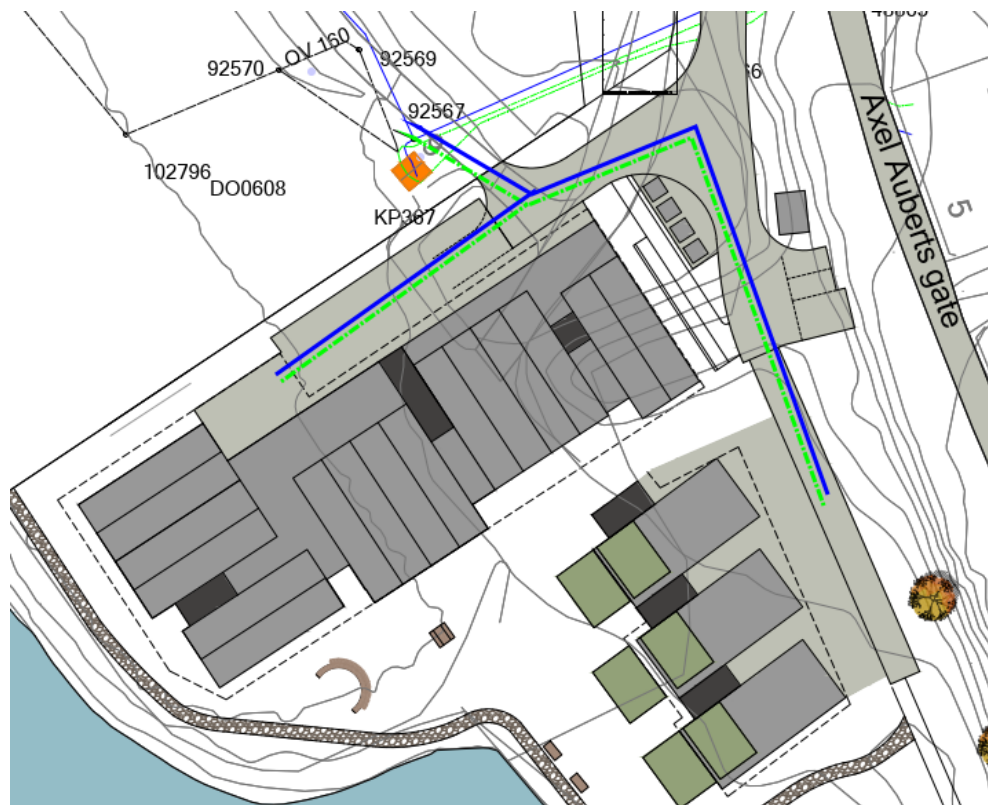
Figur 2-4 Foreslått trasé for vann og spillvann
