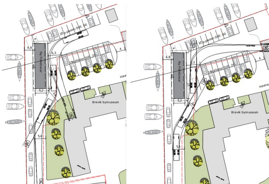
Figur 18: utsnitt av illustrasjonsplan som viser svingradier for lastebil til og fra pumpehuset og parkeringsplasser på torget. Løsning godkjent av kommunalteknikk.
